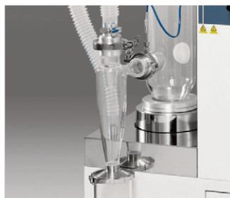
干燥腔、旋风分离器、生成物容器的拆卸或清洗采用的是快插方式，可以很方便的进行。
